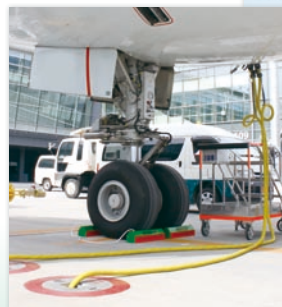
▲固定式GPUによる電気供給
