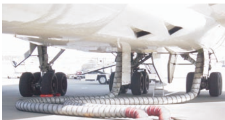
▲ GPU固定式：冷暖房気
